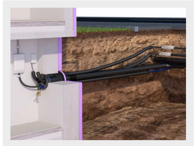
Strom/Fernwärme/Wasser/Telekommunikation Querschnitt gemäß Hauff-Technik, Kabel und Rohrdurchführungen
