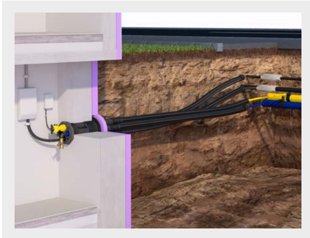
Strom/Gas/Wasser/Telekommunikation Querschnitt gemäß Hauff-Technik, Kabel und Rohrdurchführungen
